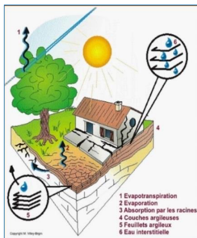
Schéma illustrant le phénomène retrait-gonflement des argiles et ses conséquences sur le bâti
